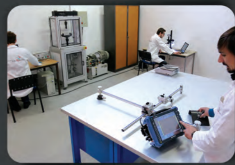
LABORATOIRE ÉQUIPÉ D'UN BANC DE TRACTION, DE COUPES MICROS ET D'UN CONTRÔLEUR US
